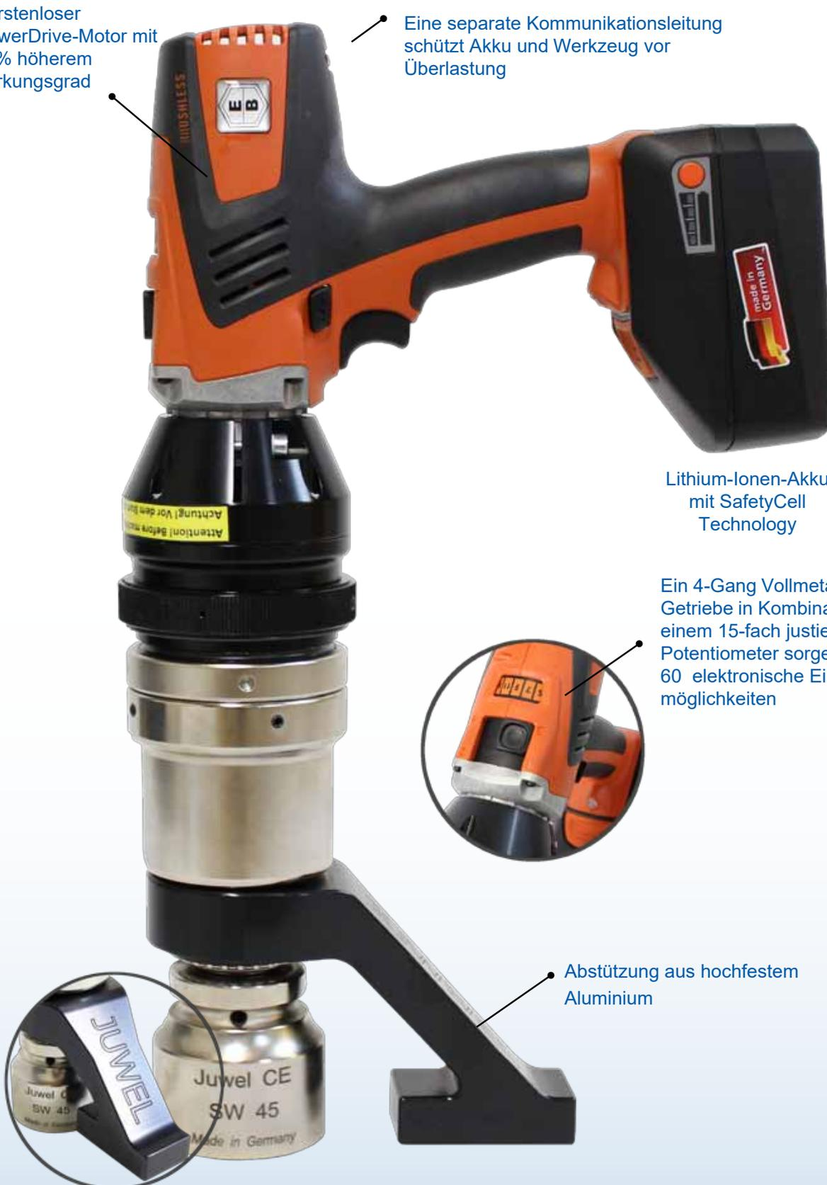
Motor und Elektronik sind komplett staubgeschützt |
