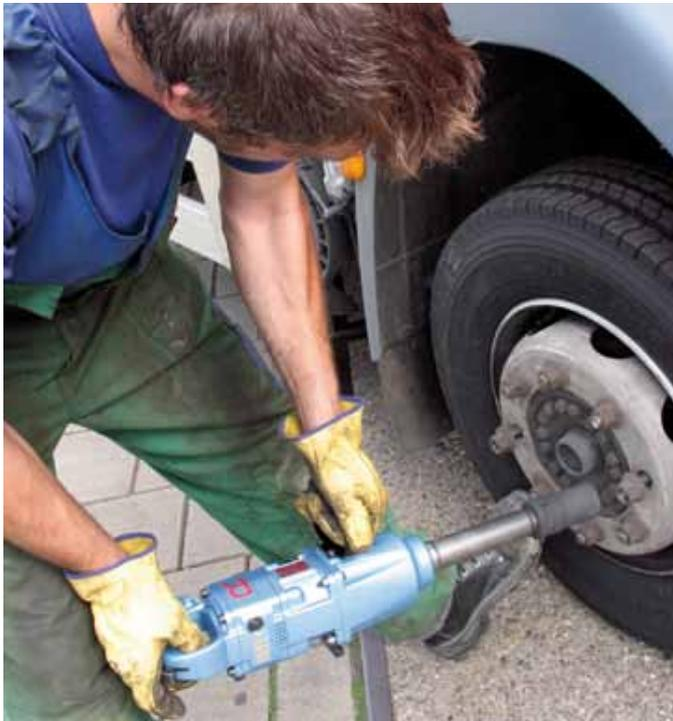
Dieser Toku Schlagschrauber ist entwickelt worden für die Reifendienste und schaltet ab bei einem voreingestellten Drehmoment (Einstellbereich 450 - 700 Nm). Dies verhindert, dass die Radmutter zu fest angezogen werden. Der Schrauber ist genauso leistungsstark im Lösebereich wie ein herkömmlicher Schlagschrauber, jedoch drehmomentkontrolliert während des Anziehens. Eine Erneuerung die zeigt, dass Toku die Bemerkungen Ihrer Kunden ernst nimmt und darauf agiert.
