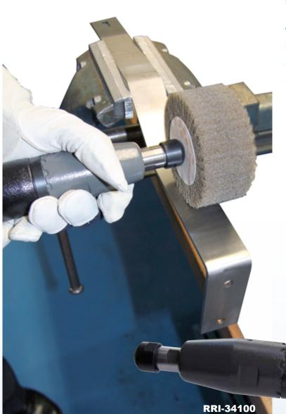
Der Red Rooster RRI-3407 Stiftschleifer mit niedriger Drehzahl ist besonders geeignet für leichte Schleif-, Putz- und Polierarbeiten an Edelstahl. Hierbei verwende man Stifte mit Gummikörper und Schleifhülsen oder auch die ScotchBrite™ Schleifkörper. Anwendung im Maschinenbau, für die Lebensmittelindustrie, im Extruder- und Behälterbau. Grobes Ausschleifen von Rohren möglich bei Verwendung eines Hartmetallfräsers.
