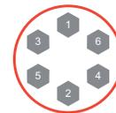
Zählt alle Verschraubungen, um sicherzustellen, dass alle Schrauben befestigt sind.
