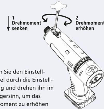
2. Stecken Sie den Einstellschlüssel durch die Einstellöffnung und drehen ihn im Uhrzeigersinn, um das Drehmoment zu erhöhen oder gegen den Uhrzeigersinn um das Drehmoment zu senken.
