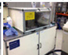
Impulsdruck-Prüfstand bis zu 4.000 bar
