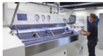
Durchflussprüfstände für Hydrauliköl und Wasser mit einer Kapazität von bis zu 300 l/min
