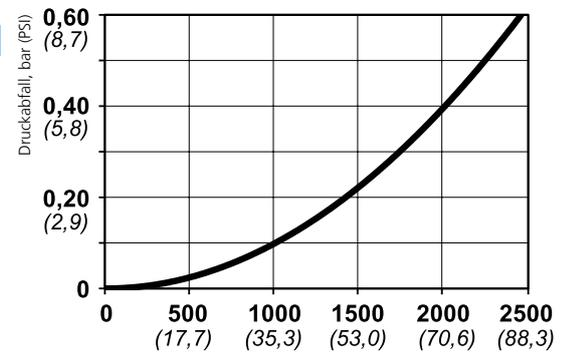
Die Durchflussmenge wird bei einem Eingangsdruck von 6 bar (87 PSI) und einem Druckabfall von 0,5 bar (7 PSI) gemessen.
