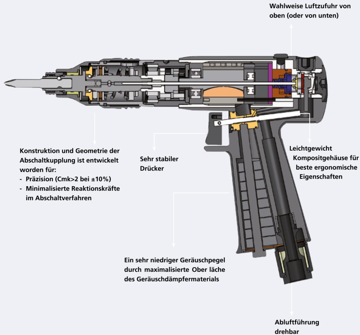
Diese Red Rooster Drehschrauber mit Abschaltkupplung haben einen großen Drehmomentbereich. Die Abschaltkupplung dieser Drehschrauber ist so konzipiert, dass sie niedrige Reaktionskräfte mit einer hohen Wiederholgenauigkeit kombiniert. Dieser Druckluftabschaltdrehschrauber ist entwickelt für die Montageindustrie.
