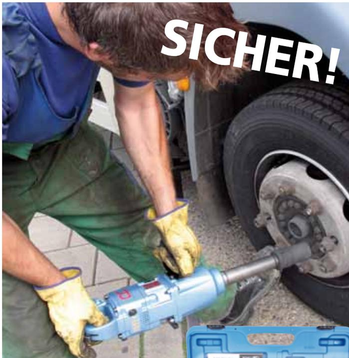
Dieser Toku Schlagschrauber ist entwickelt worden für die Reifendienste und schaltet ab bei einem voreingestellten Drehmoment (Einstellbereich 450 - 700 Nm). Dies verhindert, dass die Radmutter zu fest angezogen werden. Der Schrauber ist genauso leistungsstark im Lösbereich wie ein herkömmlicher Schlagschrauber, jedoch drehmomentkontrolliert während des Anziehens. Eine Erneuerung die zeigt, dass Toku die Bemerkungen Ihrer Kunden ernst nimmt und darauf agiert.
