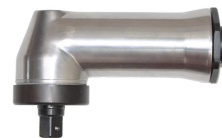
4UA9 03070216 1/2" Winkelkopf (Drehzahlreduzierung: 25%, Drehmomentreduzierung: mehr als 50%)
