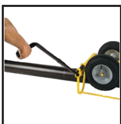
1 Rohr mit Ratschengurt an Cricket befestigen
