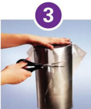
Schritt 3: Wasserlösliche Folie kreisrund ausschneiden. Kreis sollte 76 mm größer als der Rohrumfang sein.
