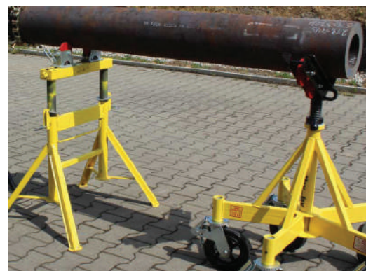
Rohrböcke zur Rohrablage
