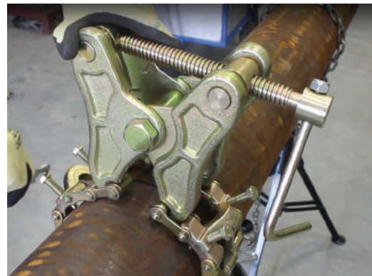
Zentrierung durch Ketten
