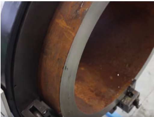
Dickwandige Rohre trennen
