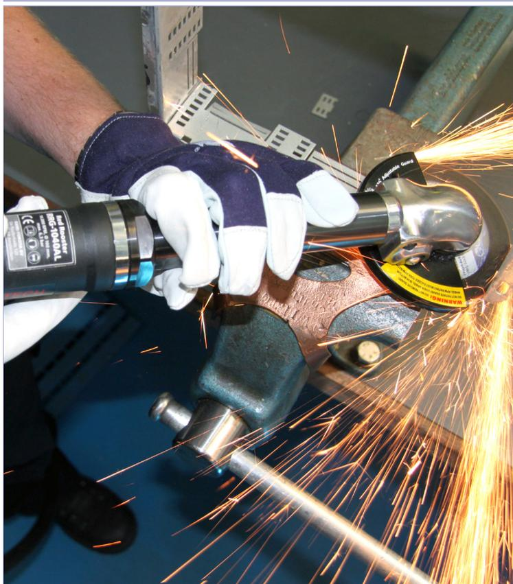
Dieser Red Rooster Winkelschleifer macht das Trennschleifen leicht. Der lange Hals mit einem Winkelkopf mit kleinen Abmessungen ermöglicht Schleif- und Trennarbeiten auch an schwer zugänglichen Stellen. Er ist der ideale Schleifer für Trennarbeiten an Karosserie und Auspuff.
