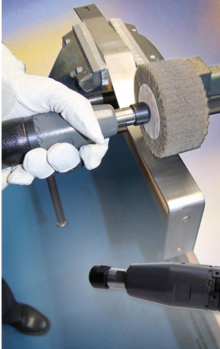
Der Red Rooster RRI-3407 Stiftschleifer mit niedriger Drehzahl ist besonders geeignet für leichte Schleif-, Putz- und Polierarbeiten an Edelstahl. Hierbei verwendet man Stifte mit Gummikörper und Schleifhülsen oder auch die ScotchBrite™ Schleifkörper. Anwendung im Maschinenbau, für die Lebensmittelindustrie, im Extruder- und Behälterbau. Grobes Ausschleifen von Rohren möglich bei Verwendung eines Hartmetallfräasers.
