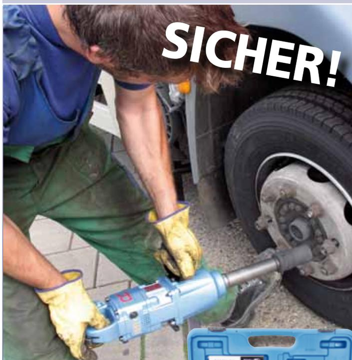
Dieser Toku Schlagschrauber ist entwickelt worden für die Reifendienste und schaltet ab bei einem voreingestellten Drehmoment (Einstellbereich 450 - 700 Nm). Dies verhindert, dass die Radmutter zu fest angezogen werden. Der Schrauber ist genauso leistungsstark im Lösebereich wie ein herkömmlicher Schlagschrauber, jedoch drehmomentkontrolliert während des Anziehens. Eine Erneuerung die zeigt, dass Toku die Bemerkungen Ihrer Kunden ernst nimmt und darauf agiert.
