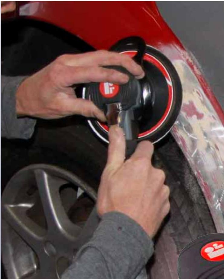
Dieser Exzentrerschleifer von Red Rooster hat eine spezielle Vibrationsdämpfung: das Gehäuse hat eine Soft-Touch-Gummioberfläche für einen guten Griff am Handballen. Anwendungsbereiche sind: Karosseriebau, Metall- und Holzbearbeitung. Der Luftmotor ist ölfrei.
